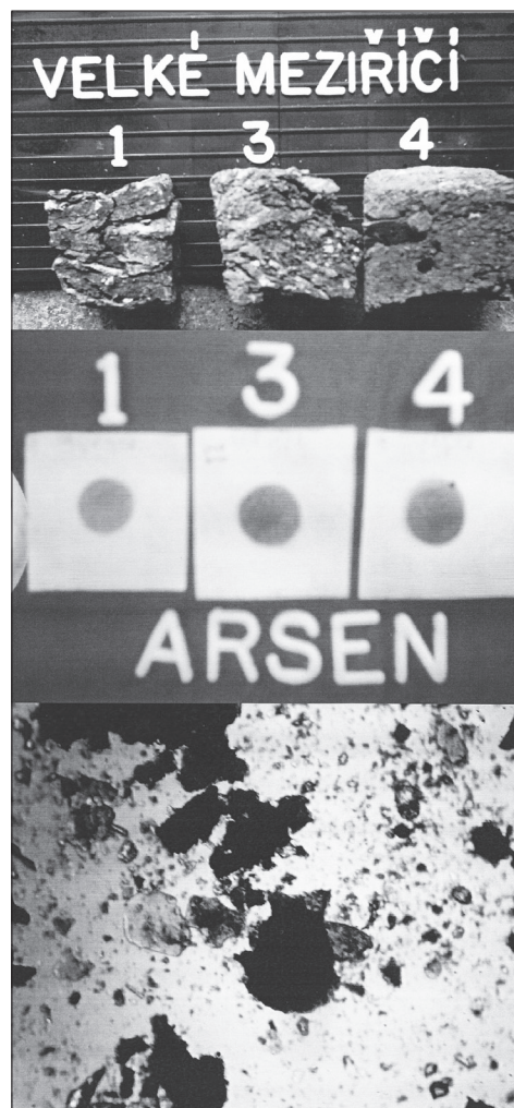
Obr. 9: Fotografická dokumentace rozboru odebraných vzorků. Od shora dolů: sledování struktury zrn krychlových vzorků, zkouška na přítomnost arzenu, mikroskopické prohlédnutí vodní suspenze zemin. Zdroj Majer 2014.
